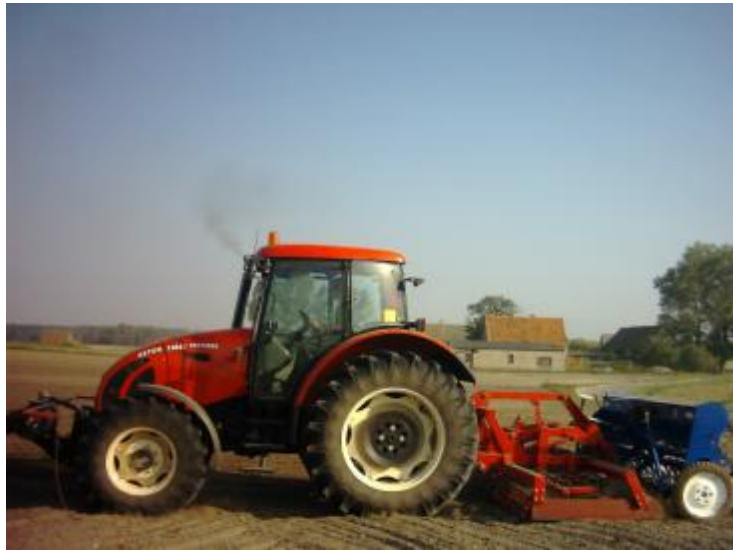
Na zdjęciu ciągnik rolniczy wraz z zestawem uprawowo – siewnym
